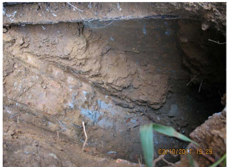
Foto n. 13: saggio S2, profondità 0.8 m, riporto sabbioso/argilloso con macerie.
